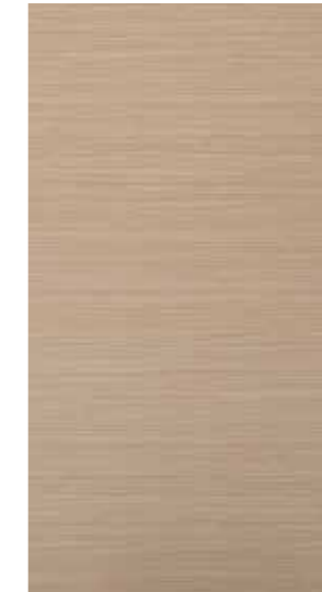
Zebrano Sand TME60 Puun värinen vaaka-pintastruktuuri-melamiiniovi, oven värisellä reunanauhalla, (korkeissa komeroissa struktuuri pystyyn), paksuus 19 mm.
